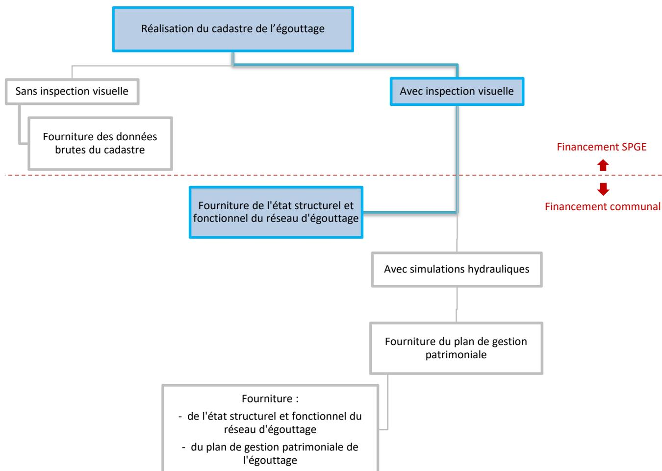
Pour obtenir **l'état structurel et fonctionnel du réseau d'égouttage**, il y a lieu de suivre les démarches représentées en bleu sur le schéma.
